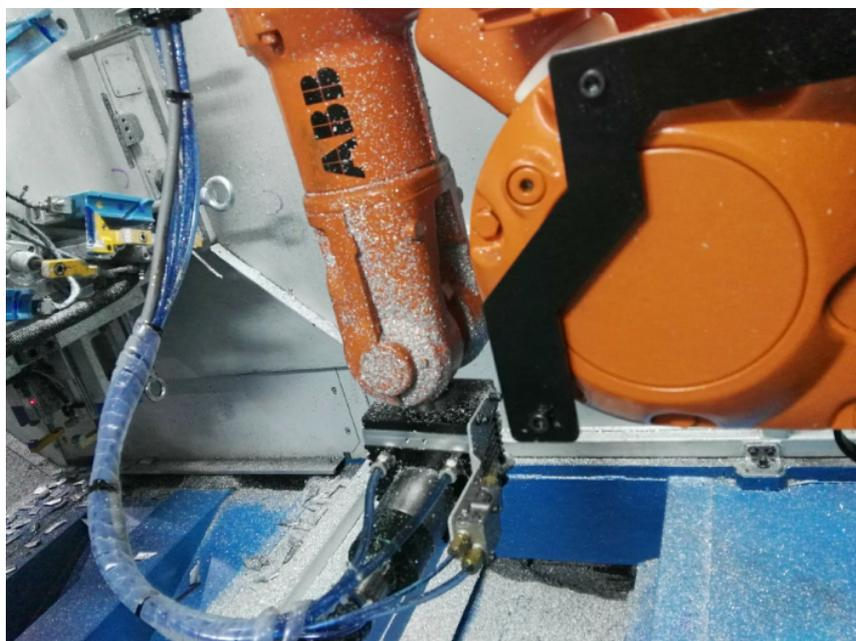
电主轴：主轴，外文名hvct是在数控机床领域出现的将机床主轴与主轴电机融为一体的新技术。主轴是一套组件，它包括电主轴本身及其附件：电主轴、高频变频装置、油雾润滑器、冷却装置、内置编码器、换刀装置等。这种主轴电动机与机床主轴“合二为一”的传动结构形式，使主轴部件从机床的传动系统和整体结构中相对单独出来，因此可做成“主轴单元”，俗称“电主轴”(ElectricSpindle, MotorSpindle)特性为高转速、高精度、低噪音、内圈带锁口的结构更适合喷雾润滑。电主轴的工作不只转速高，而且要求有很高的角减速度和角加速度。常州伺服电主轴销售公司
